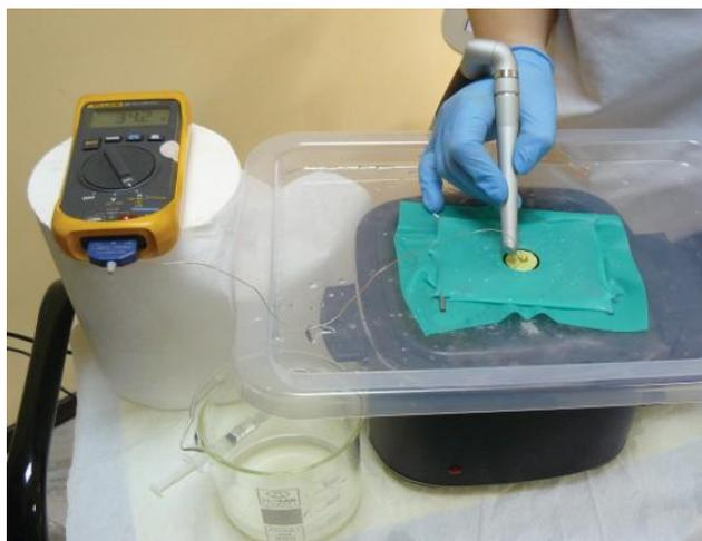
**Figure 1.** 実験設定 – 恒温システム内の歯のサンプル。熱測定システムはサンプルの歯髓腔内に設置される。
